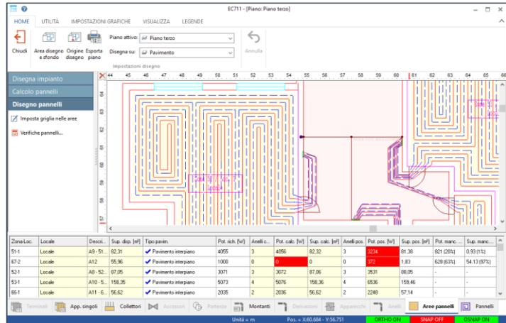
La possibilità di disegnare con lo stesso strumento sia impianti tradizionali, sia impianti a pavimento (possibile quando si posseggono entrambi i moduli: EC717 e EC718), rende il software EC711 un importante e completo strumento per la progettazione termotecnica.
