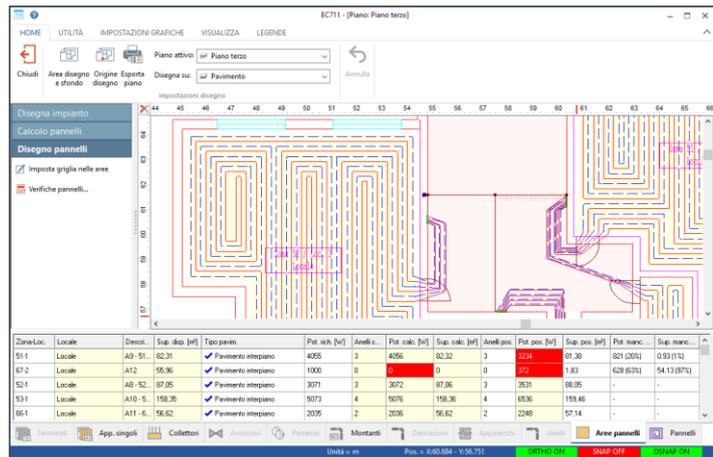
Il modulo EC717 permette sia di disegnare manualmente i pannelli radianti, suggerendone le caratteristiche fondamentali: numero di anelli necessari, passo dell'anello, lunghezza massima, ecc.; sia di visualizzare automaticamente il disegno del pannello
